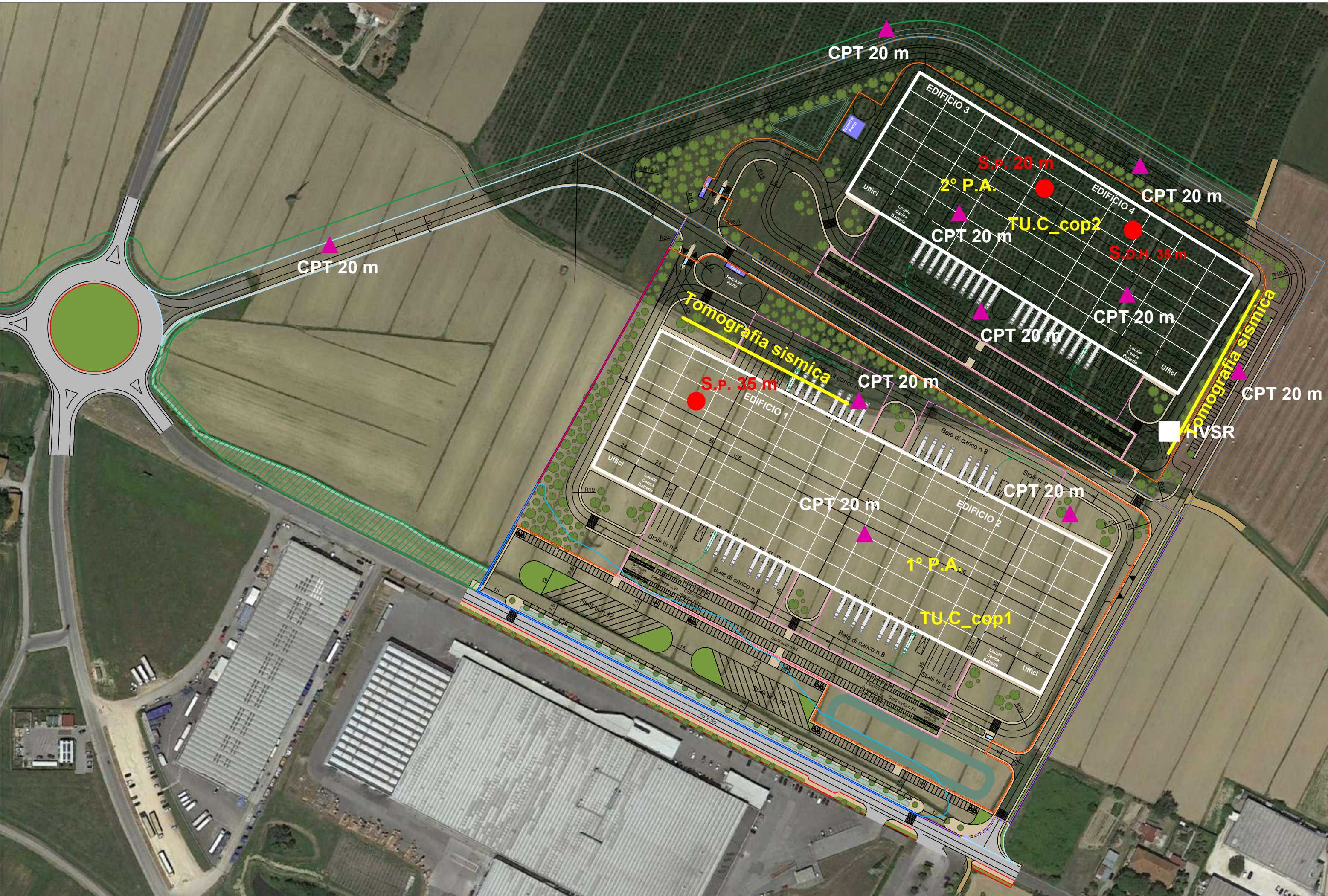
FIGURA 15: Planimetria generale con ubicazione nuove indagini geognostiche e sismiche (scala 1:2000)
