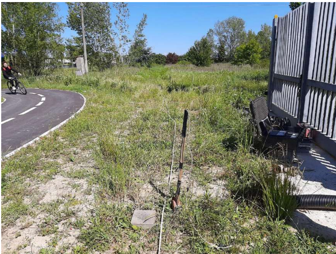
Figura 3: Stendimento sismico MASW1
