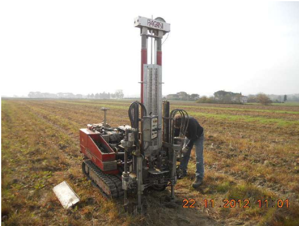
Figura 1: Prova penetrometrica CPT1
