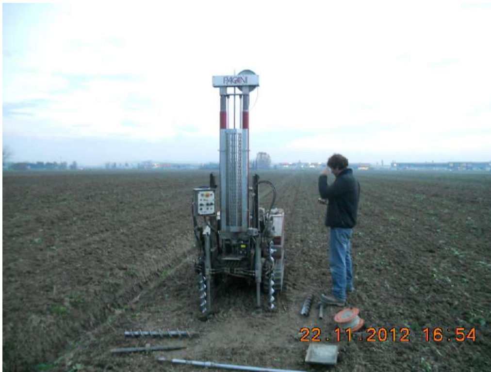
Figura 5: Prova penetrometrica CPT5
