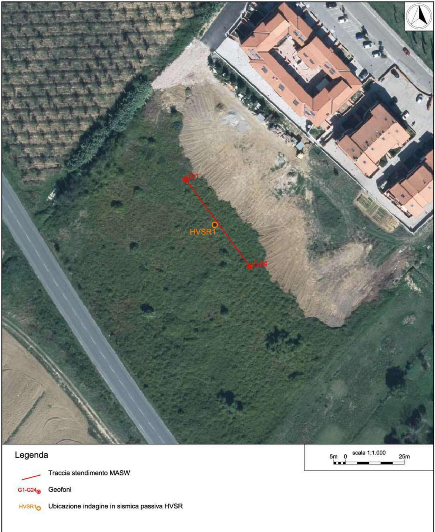
Figura 3. Ubicazione stendimento MASW e indagine in sismica passiva HVSR – Particolare su base ortofotocarta.
